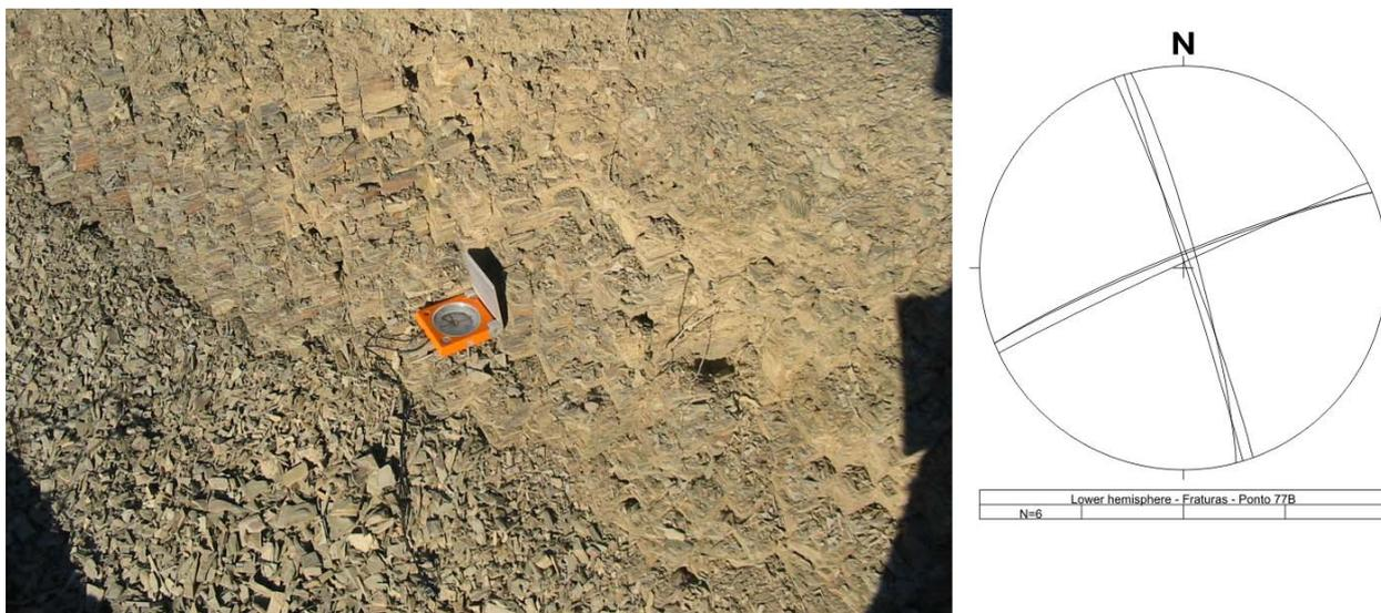
Figura 4.54 – Folhelho com fraturas perpendiculares bastante penetrativas (ponto 77)
