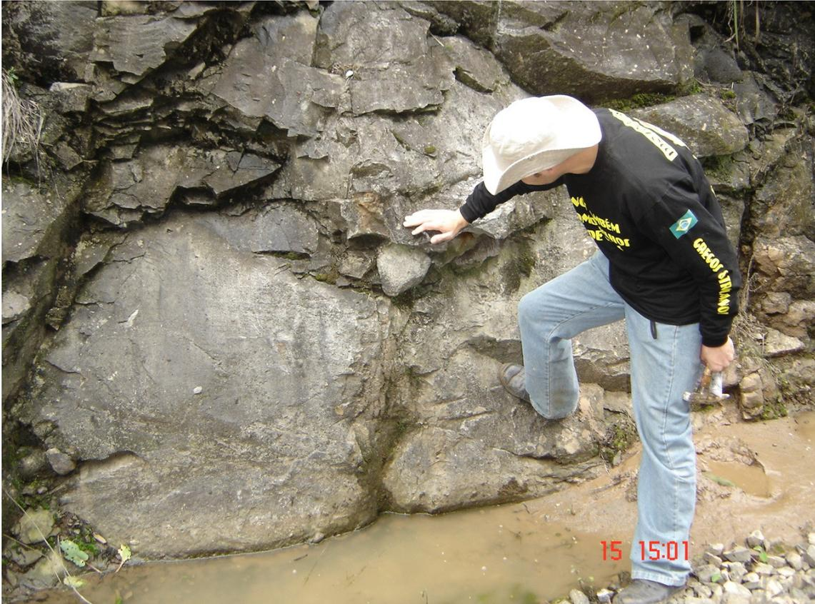
Foto 16 – IP 12 Diamictito – corte da ferrovia – Fundação Hildebrando. Detalhe da foto anterior, mostrando blocos de rochas diversas de tamanhos variados.
