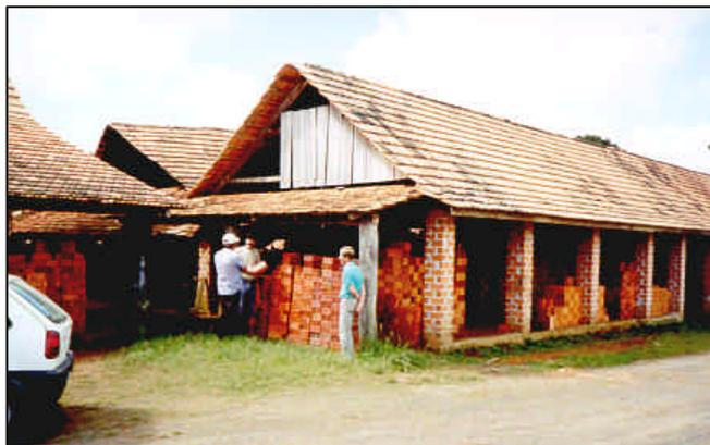
Foto 4. Barracões de secagem da Cerâmica Levandowski, pertencente à empresa A. Ulbrich & Cia. Ltda.
