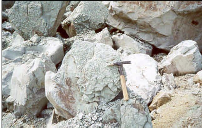
Foto 11. Detalhe dos siltitos e argilitos utilizados na pavimentação de estradas em Rio Azul.
