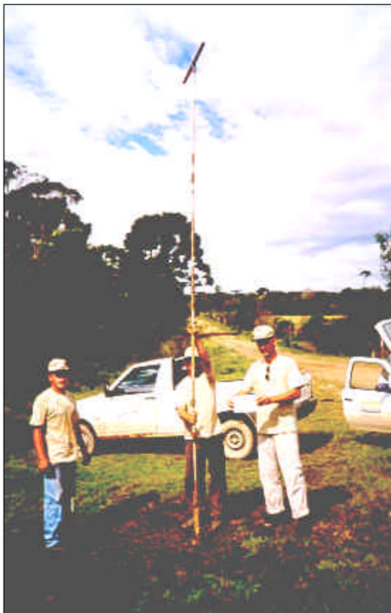
Foto 7. Execução de furo a trado para a coleta de amostra de caulim.
