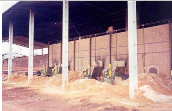
**Foto 11** – Queima de serragem em forno de cerâmica da RMC.
