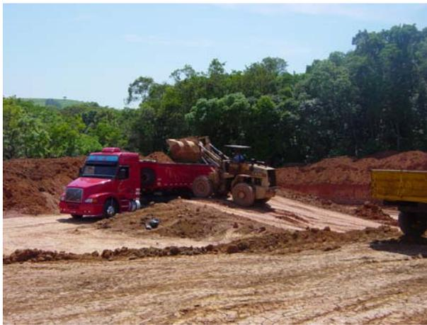
**Foto 1** – Carregamento de argila no barreiro Barra Grande em Curiúva.
