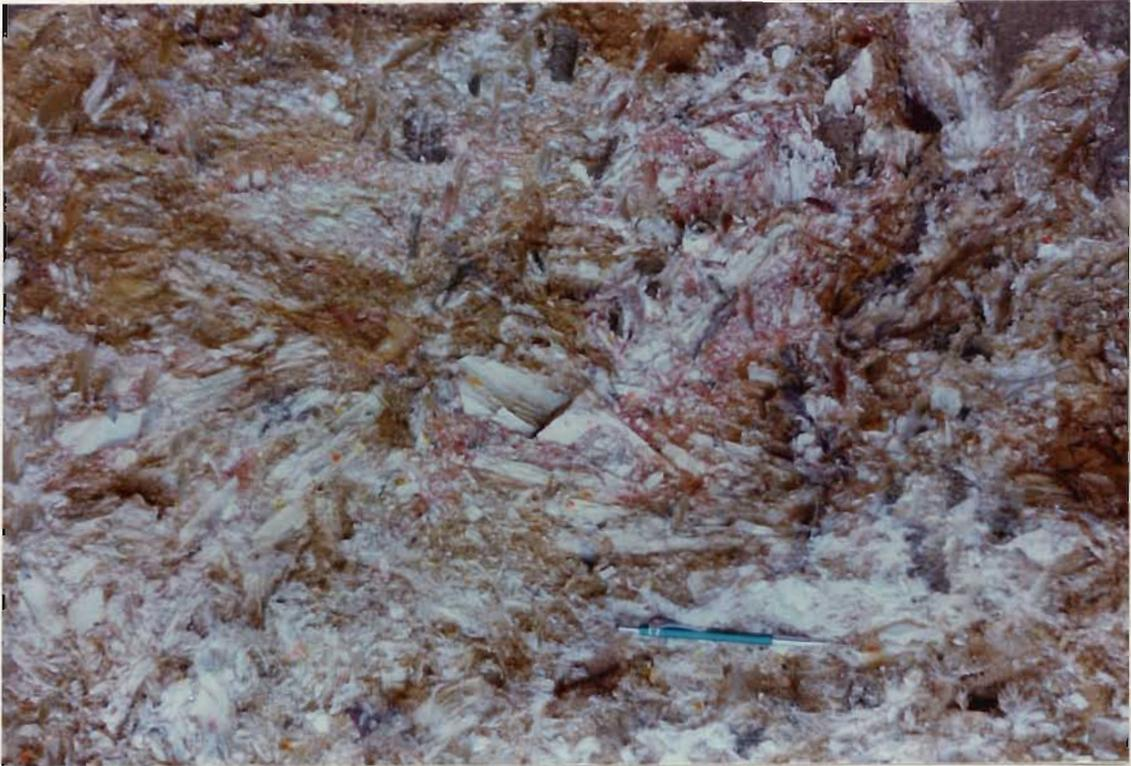
FOTO 3.3 - Material brechado em um trecho da Falha da Lancinha. O material caracteriza-se por um aglomerado de fragmentos angulosos, com predomínio de quartzito.
