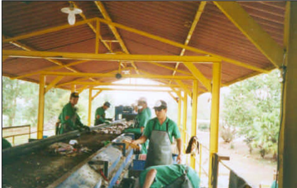
**Foto 29.** Detalhe do circuito de reciclagem de lixo, sem prévia separação na coleta (ponto MC-11).
