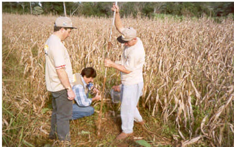
Foto 18. Detalhe da amostragem de argila na várzea do rio Capanema.
