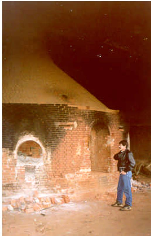
Foto 12. Boca do forno do tipo garrafão da olaria de Dionísio Cerqueira, que abastece Barracão.
