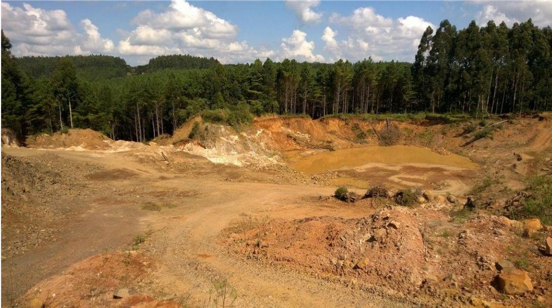
Foto 18: Lavra de sill de diabásio dentro da área urbana de Inácio Martins. O detalhe é que o diabásio está na forma de um sill de 10 metros de espessura, com arenitos capeando e em posição inferior ao mesmo. EC LL-1194. Carta 2853-2, Inácio Martins.
