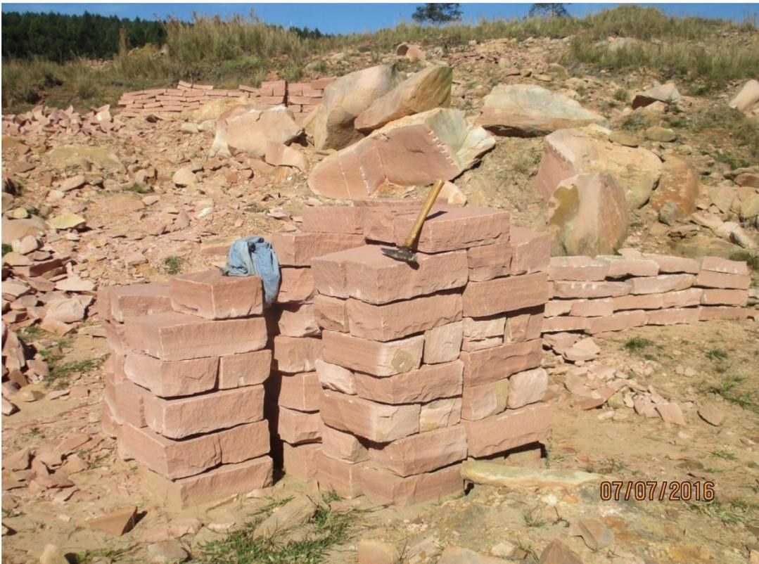
Foto 58: Lavra e produção de paralelepípedos de arenito silicificado EC AC-1691. Carta 2784-4, Mauá da Serra.
