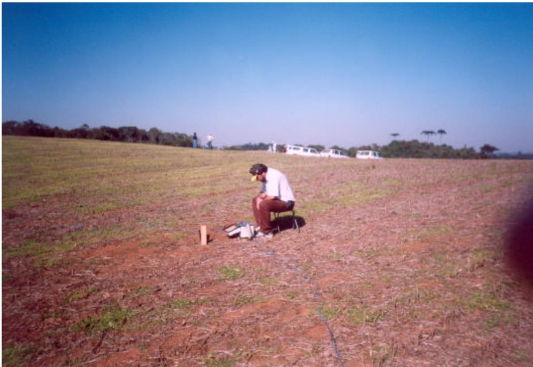
Foto 06 - Área A-134c, imageamento elétrico - leitura de cargabilidade e resistividade em perfil
