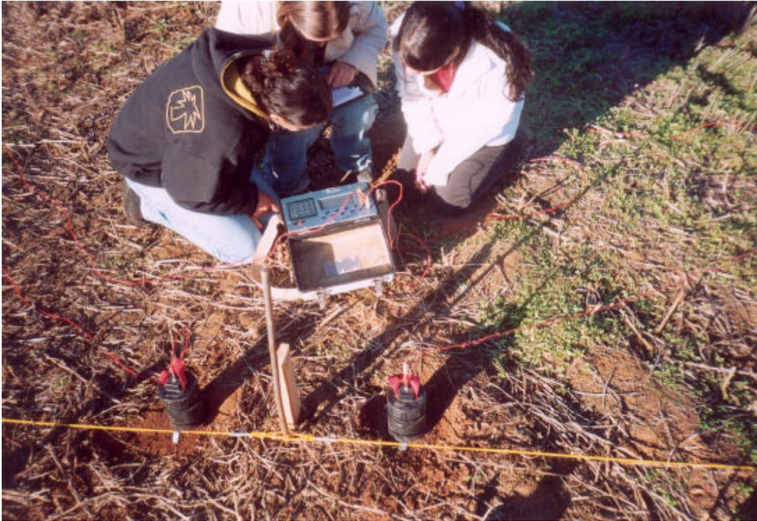
Foto 07 - Área A-134c, imageamento elétrico detalhe da leitura de cargabilidade e resistividade
