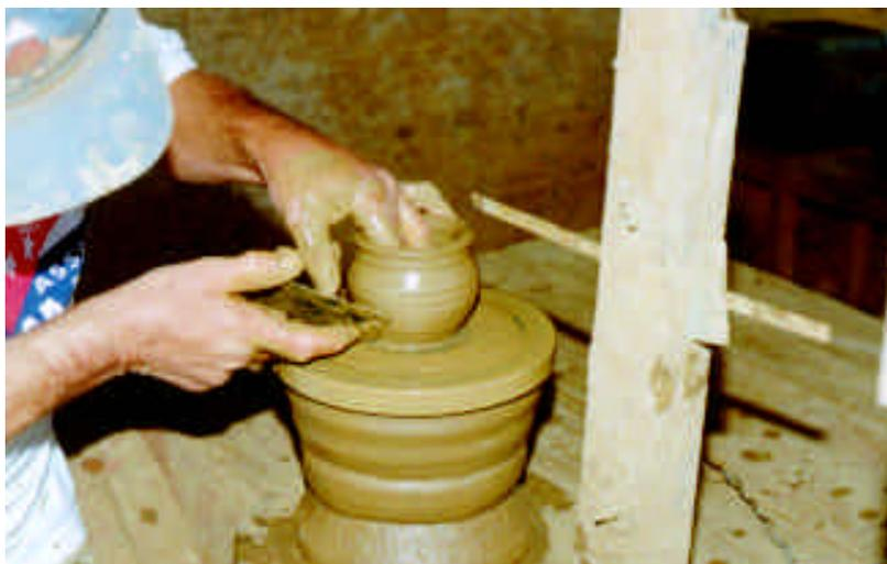
Foto 4. Modelagem de vaso em torno da fábrica de Ibiporã.
