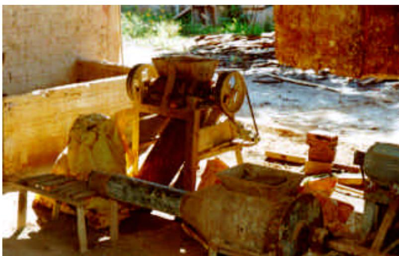
Foto 2. Equipamentos para preparação da massa na fábrica de vasos de Ibiporã.
