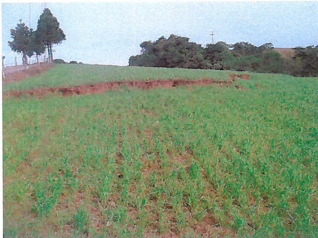
Foto 1 - Local onde iniciam-se os escorregamentos, notar o pacote de colúvio sobre o saprólito de basaltos.
