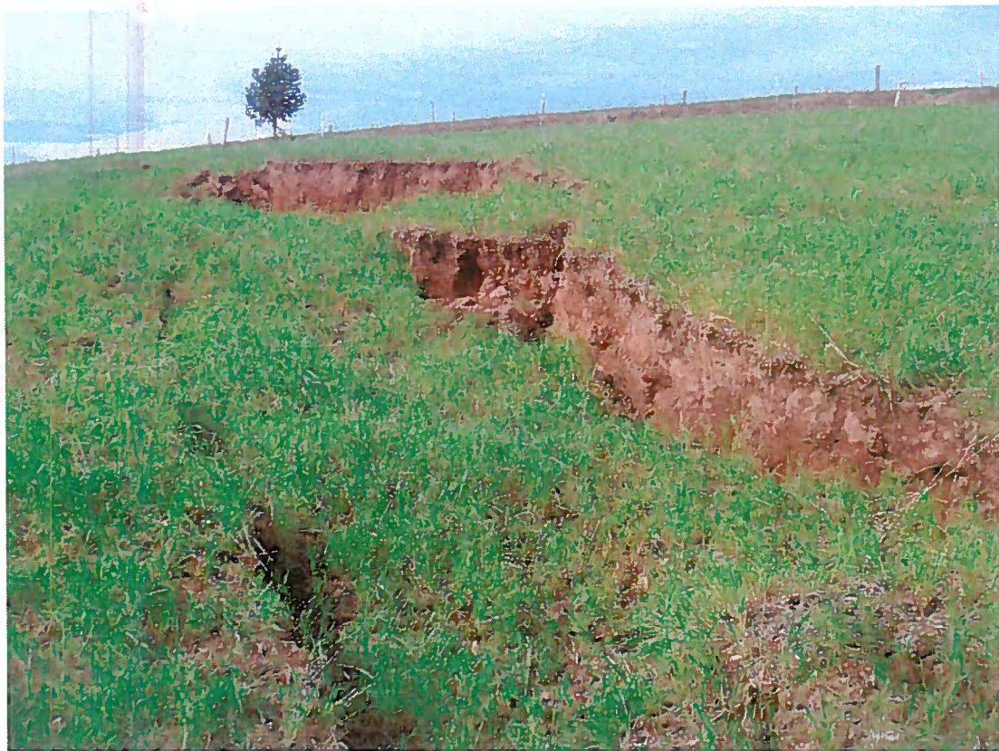
Foto 2 - Detalhe do material coluvial, mostrando a heterogeneidade e a abertura das fissuras.
