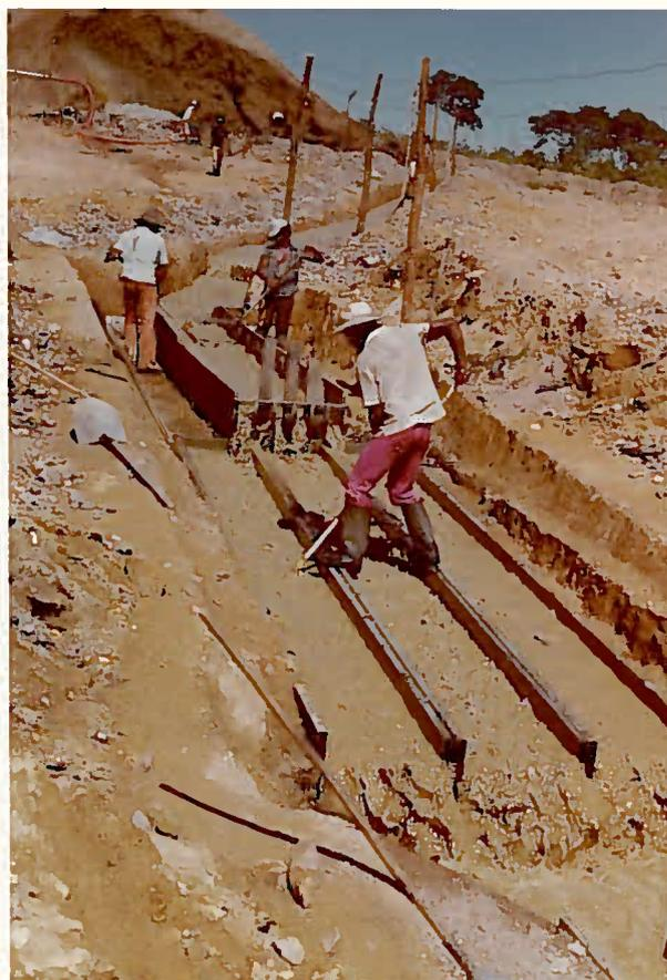
Foto - 12: Vista geral do conjunto de concentração em plena operação. Ao fundo, o canhão d'água operando no desmonte da pilha de minério. O canal de alimentação derrama a polpa na bica superior, constantemente remexida por um ou dois homens, e, daí, para as bicas inferiores, também remexidas por um homem. O que passar pelas bicas é considerado rejeito. Este arranjo, bem ajustado, tem permitido a recuperação de minério com granulometria de até 200 mesh.
