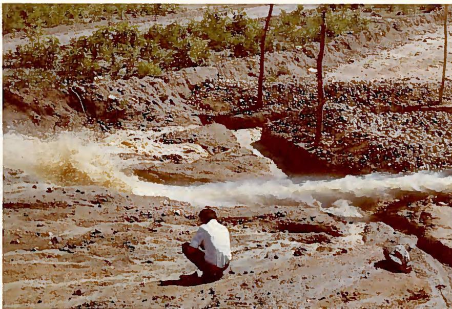
Foto 5 - Notar que o minério desmontado origina a polpa que é captada pelas bocas de captação, caindo no canal de captação. Este canhão d'água (monitor) é marca Haupt (fon. 260.3984 em São Paulo) e é alimentado por uma bomba KSB 100-50/2, de altura manométrica de 80 m e vazão de 160 m<sup>3</sup>/hora. O motor da bomba é um MWM de 100 HP.
