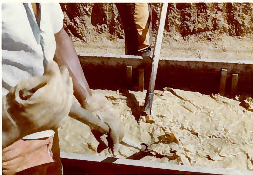
Foto 8 b: Detalhe da bica superior. Notar os encaixes, na calha, feitos para receber os ríflés. Cada ríflé tem 5 cm de altura e, quando entulhado de minério, lhe é superposto um outro ríflé de 5 cm, fazendo uso do encaixe mostrado na foto. Isto permite aumentar o tempo de corrida e a rentabilidade do processo.
