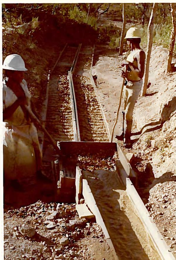
Foto 10: Neste arranjo, o canal de alimentação deságua em duas bicas superiores que, por sua vez, desaguam em outras duas bicas, inferiores. A foto mostra uma peneira de malha de 2 cm. Este artifício permite a obtenção de uma polpa mais homogênea, facilitando a concentração nas bicas. A malha da peneira depende da granulometria do minério a ser concentrado.
