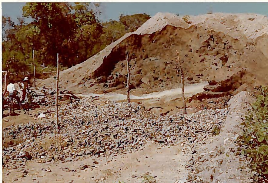
Foto 4 - Desmonte da pilha de minério com o canhão d'água (monitor). O jato é regulado de modo a proporcionar a formação de uma polpa na qual a razão água/minério é de cerca de 10/1. Isto é conseguido pelo operador, com o auxílio dos auxiliares encarregados das bicas, que dirão se a polpa é rica (bicas entulham) ou pobre (bicas recebem lama e pouco cascalho). Com o tempo, o operador, sozinho, será capaz de otimizar o fluxo d'água do canhão.
