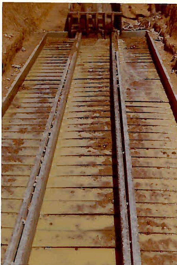
Foto 11: Bicas inferiores, com a água desligada, ao fim da corrida. Em qualquer momento que se desligar a água, as bicas ficarão aparentemente entulhadas, como na foto. Não é este entulhamento que determina o fim da corrida, e sim a presença de minério junto aos últimos ríflés das bicas inferiores. O cascalho que entulha os inter-ríflés é removido, após a raspagem das calhas, por um pe neiramento à 4 mm.
