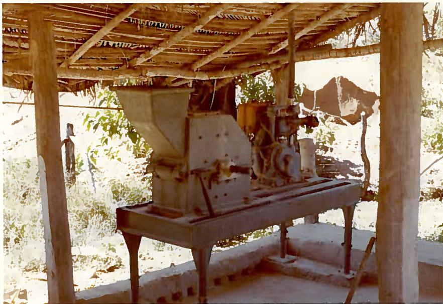
Foto - 15: Moinho de mandíbulas, movido por um motor Agrale de 11 CV. A amostra é moída a 4 mm. Usado para homogeneização de eluvios grosseiros ou de amostras de minério primário, obtidas nos poços e trincheiras usados na cubagem.
