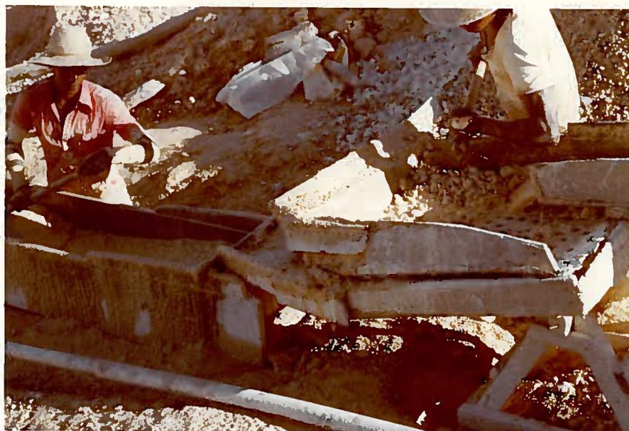
Foto 13: Em um arranjo feito por garimpeiros, notar a instalação de uma peneira (ralo) antes da bica superior. Esta peneira é constantemente limpa por um homem, que preocupa-se em agitar bem o material antes de o retirar do ralo, possibilitando uma boa deslamagem dos grânulos.
