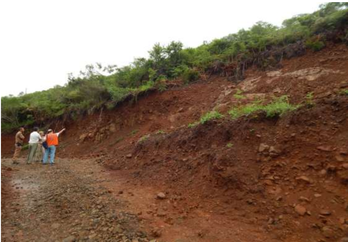
Foto 2: podemos observar a camada de colúvio com blocos arredondados sobre a rocha sã.
