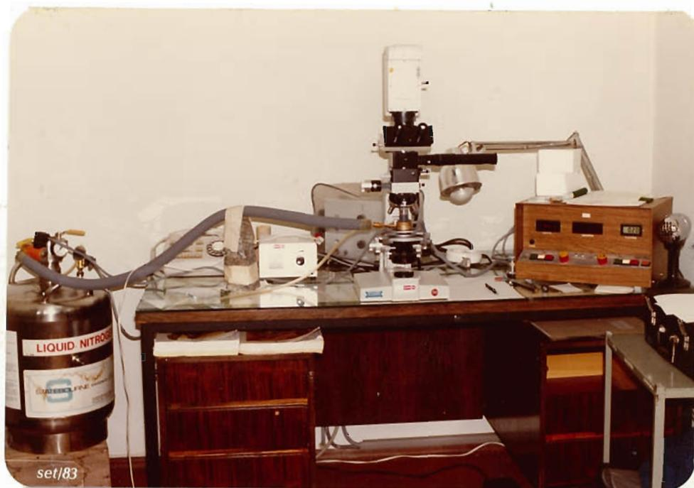
Foto 1: Equipamento CHAIX-MECA para estudo de inclusões fluidas, montado em microscópio LEITZ, mod. ORTHOLUX II POL-BK com câmara clara.
